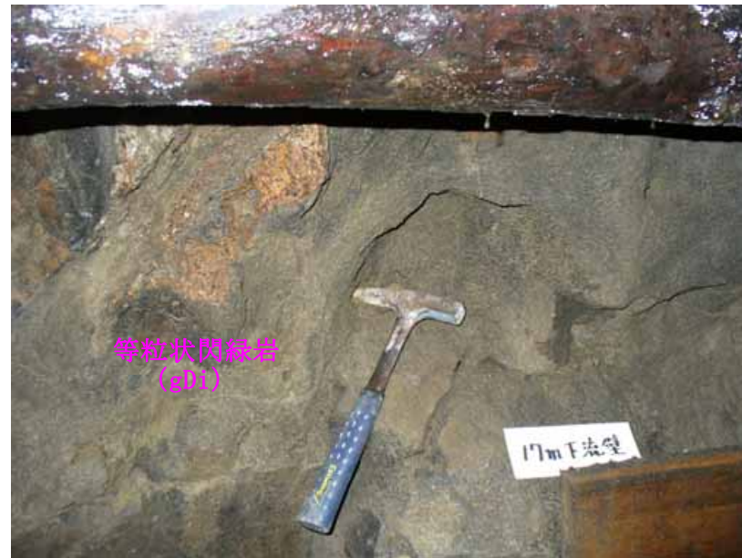
写真-3.3.1 TR-5 坑 17m 下流壁のマサ化した等粒状閃緑岩 (gDi)
