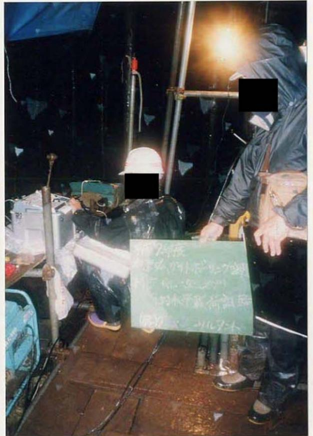
孔内水平載荷試験状況
