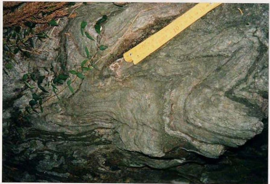
写真4-1-6 微褶曲する片麻状構造
