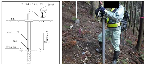
図 2.3.1 触針式地下水位計観測 模式図・観測状況写真 (SL-4G1 孔)
