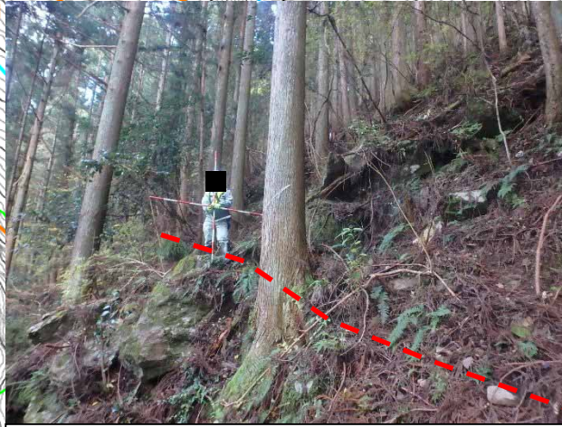
④ 末端部：崖錐堆積物と岩盤の境界に推定。
