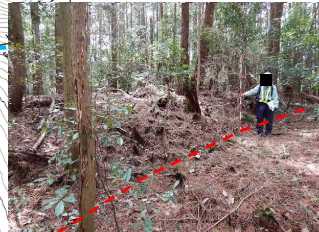
⑥ 頭部：段差地形 (高さ 1m) 下端に推定。
