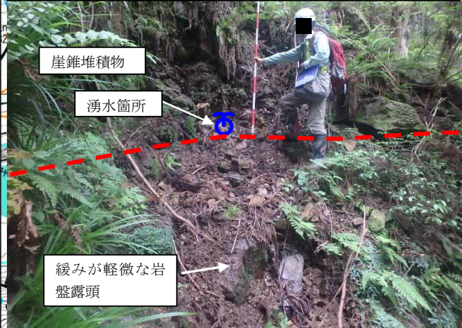
② 末端部：崖錐堆積物と緩みが比較的軽微な岩盤との境界 (湧水箇所) に推定。
