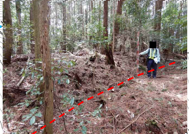
⑥ 頭部：段差地形 (高さ 1m) 下端に推定。
