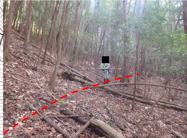
① 頭部：滑落崖下端の遷緩線に推定。
