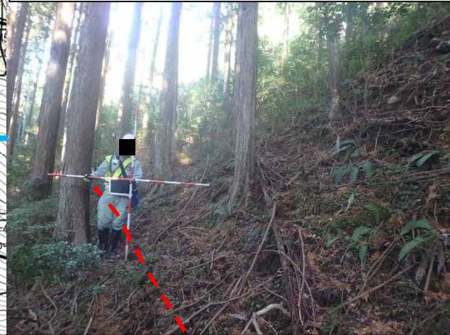
⑥ 頭部：滑落崖下端の遷緩線に推定。
