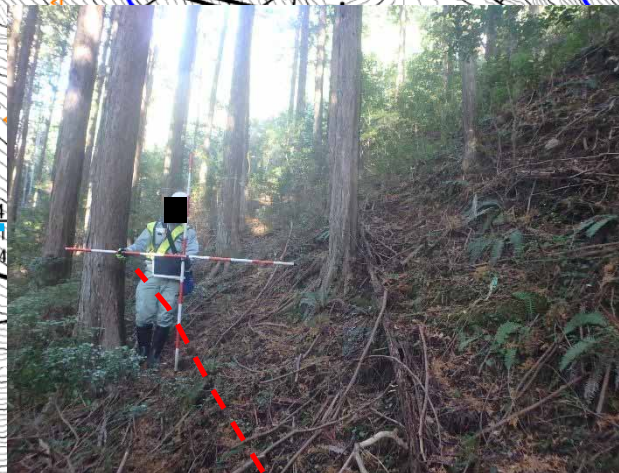
⑥ 頭部：滑落崖下端の遷緩線に推定。
