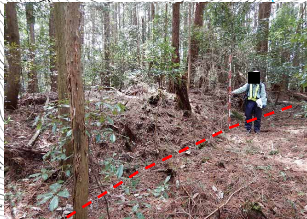
① 頭部：段差地形 (高さ 1m) 下端に推定。
