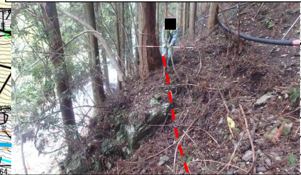
④ 末端部：緩みの比較的軽微な花崗岩上面に推定。
