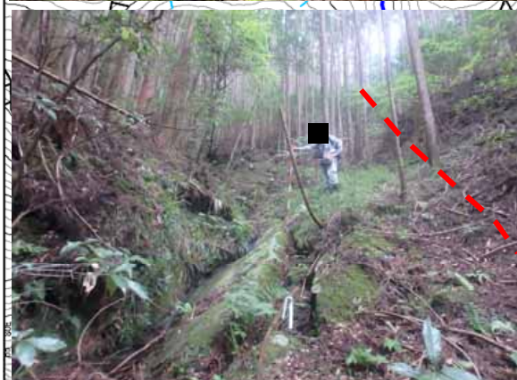
② 上流側部：堅岩露頭が分布する溪流の左岸側に側部境界を推定。
