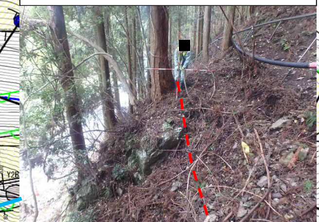
④ 末端部：緩みの比較的軽微な花崗岩上面に推定。
