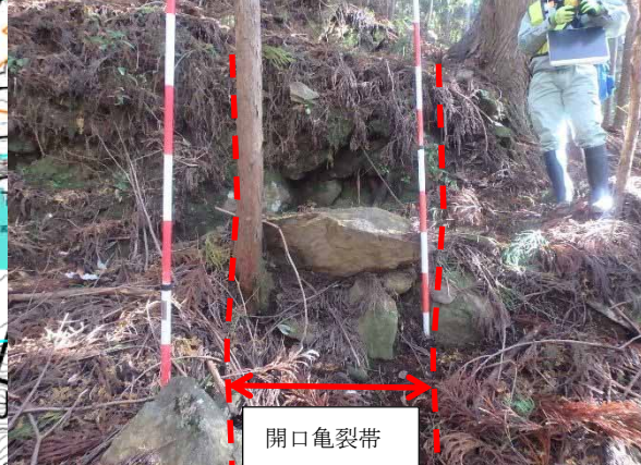
② 上流側部：開口亀裂帯に推定。
