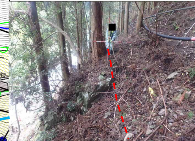
④ 末端部：緩みの比較的軽微な花崗岩上面に推定。
