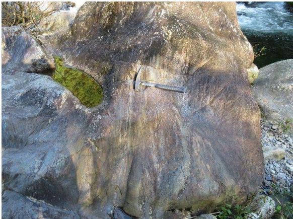
58 砂質片麻岩～縞状片麻岩の硬質露頭。片麻状構造は見られるが、弱面とはなっていない。
