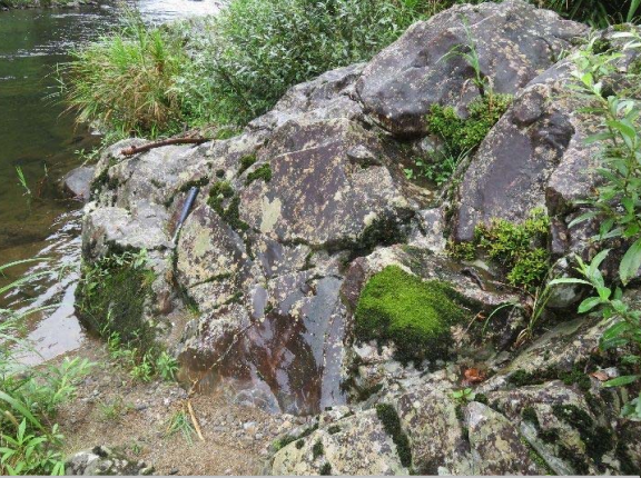
6 J4-7下の河床。砂質片麻岩の硬質な露頭。片麻状構造自体が主要な分離面となっていない。
