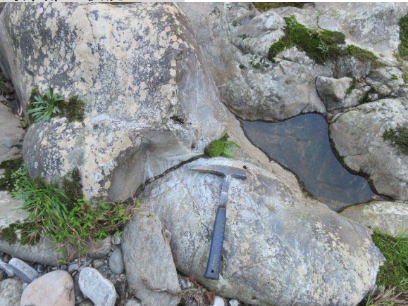
56 本流右岸河床部に分布する砂質片麻岩～縞状片麻岩。非常に硬質で、片麻状構造が目立たない。
