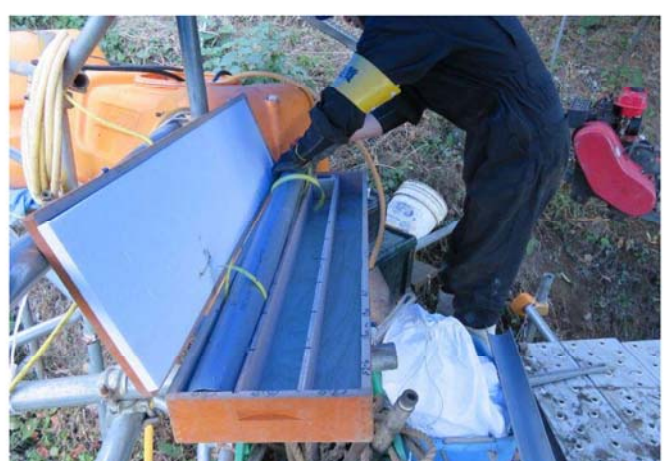
写真 3.3.4 塩ビ上蓋を被せ、2 本の紐で吊るして収納
