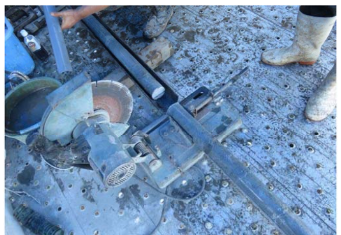
写真 3.3.2 1m 長塩ビ管の切れ目でコアを切断。
