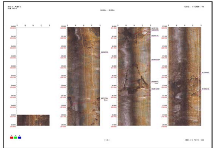
図 3.4.4 孔壁展開図の例
