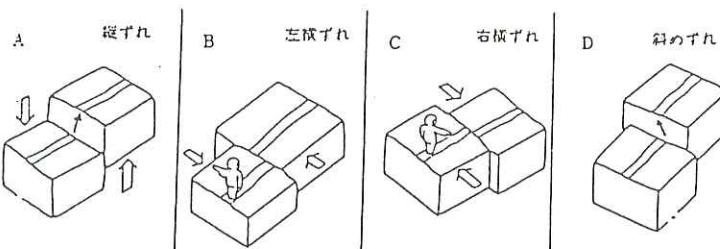
図-II 断層のずれ（変位）による分類
