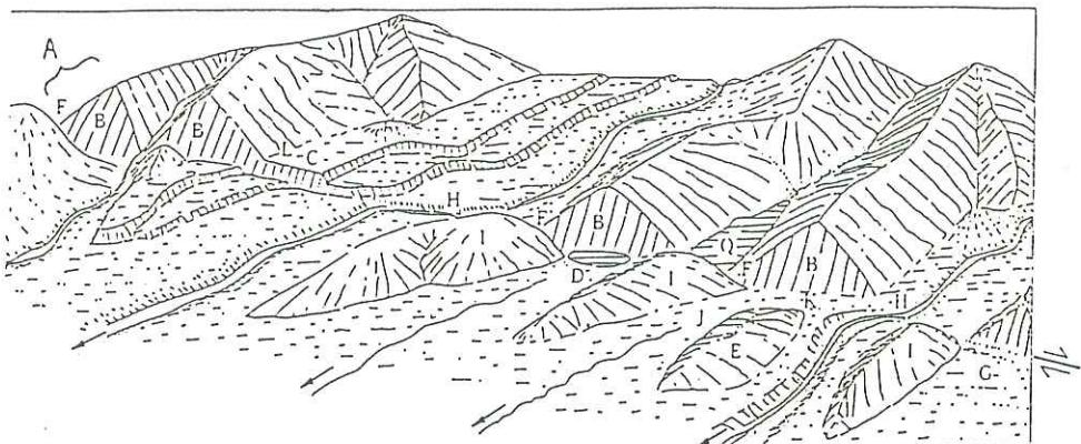
図-I 右ずれ断層による変位地形の諸例 (岡田, 1979を改訂)
