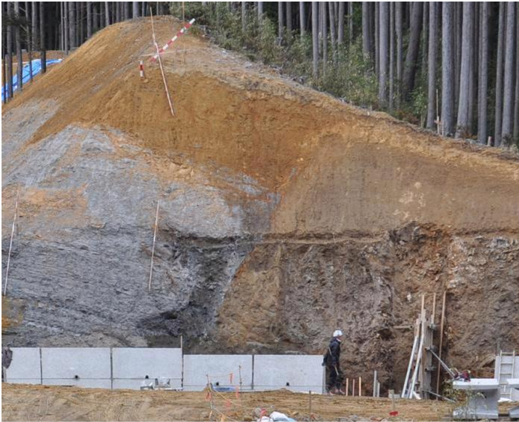
写真：われわれの現地調査で発見した断層の露頭。（第四紀に形成された）表層の風化層まで変位されている。
